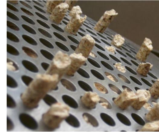
Holzspäne werden durch eine Matrice gepresst – so entstehen Pellets.
